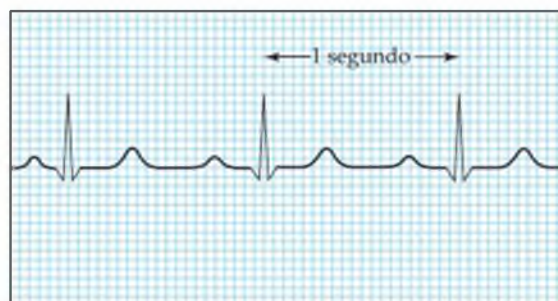
▲ Figura 20.18 Un electrocardiograma típico. Un electrocardiograma (ECG) impreso registra los sucesos eléctricos detectados por los electrodos adheridos a la superficie del cuerpo. El eje horizontal es el tiempo y el desplazamiento vertical es la fem.
